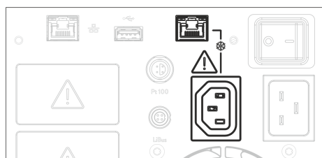
Fig. 29: Prise de connexion des câbles du bain de froid
